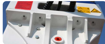
▲ Water jets for dust suppression (optional).
